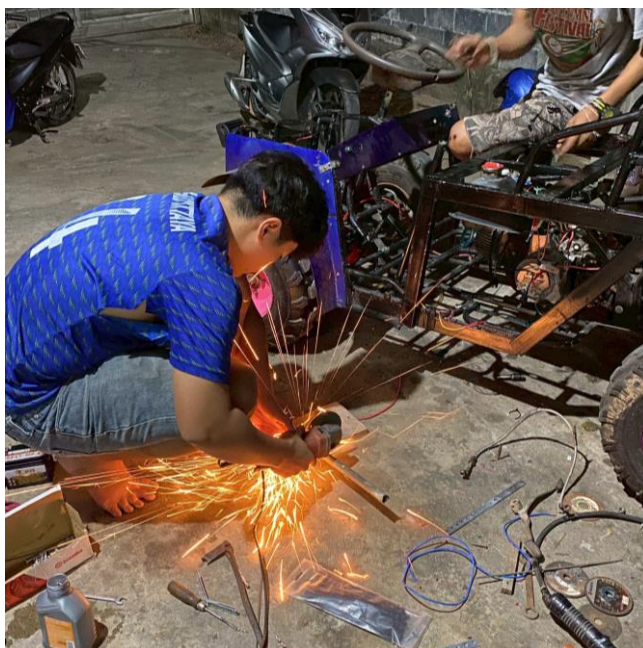
รูปภาพที่ 9.5 ตัดเหล็กเพื่อเชื่อมคันเกียร์ไปยังแกนเกียร์
