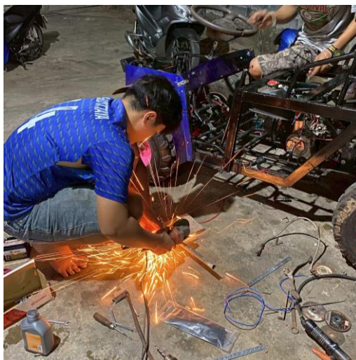
ภาพที่ 4.2.2 ตัดเหล็กเพื่อทำการเชื่อม
