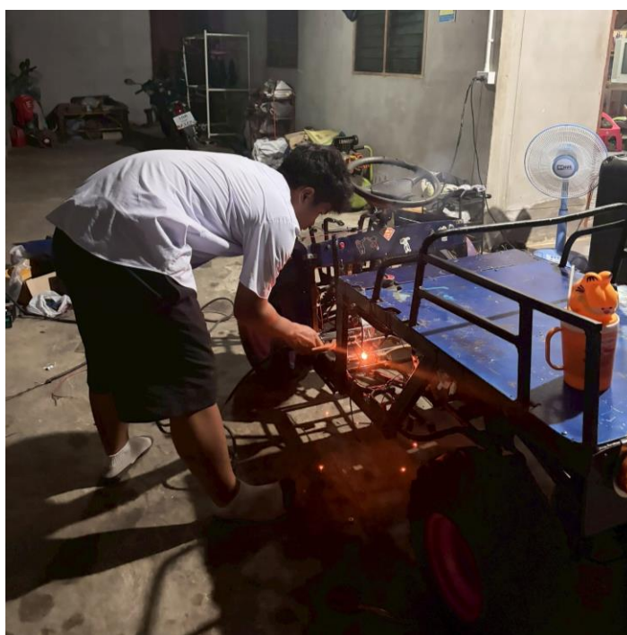
รูปภาพที่ 9.6 เชื่อมเหล็กคันเกียร์ไปยังแกนเกียร์
