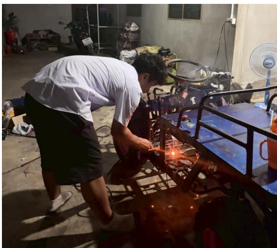
ภาพที่ 4.2.3 เชื่อมเหล็กไปจากก้านเกียร์ไปยังแกนเกียร์
