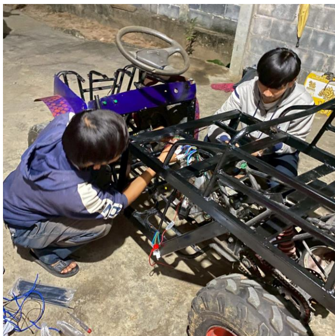
รูปภาพที่ 9.1 ถอดชุดสื่อกเพื่อทำสี่โครงใหม่
