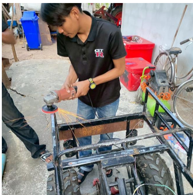
รูปภาพที่ 9.2 ขัดพื้นผิวโครงเพื่อทำสี
