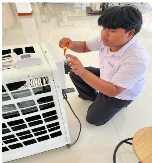
รูปภาพที่ 5 ขั้นตอนการต่อมอเตอร์
