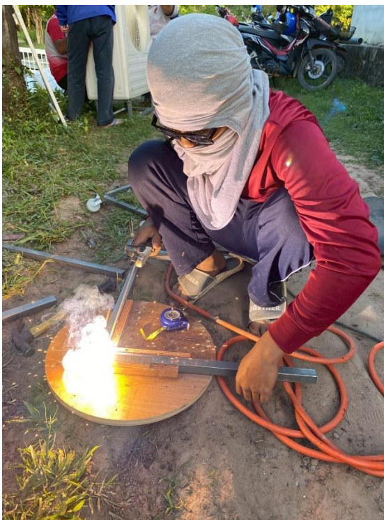
รูปภาพที่ 3 การเชื่อมโครงเหล็กเพื่อประกอบชิ้นงาน
