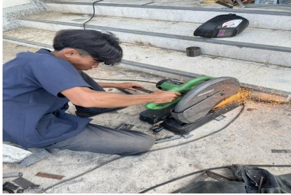
ภาพที่ 1 การตัดเหล็กทำโครง (ที่มา นางสาวธัญวรรณ พรหมพิลา และคณะ 2568)
