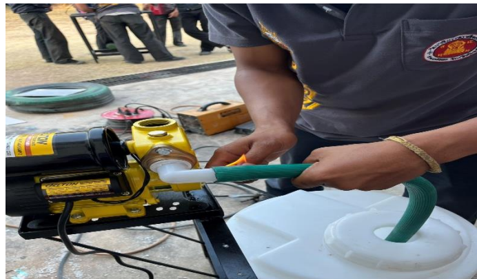
ภาพที่ 3.2.10 การต่อสายยาง (ที่มา : นายจรรย์ศ ทงประเสริฐ และคณะ 2568)
