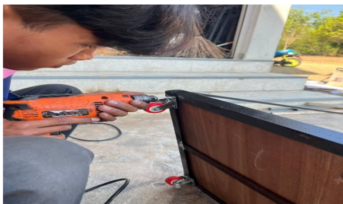
ภาพที่ 3.2.8 การยิงสกรูติดล้อ (ที่มา : นายจรรย์ศ ทงประเสริฐ และคณะ 2568)
