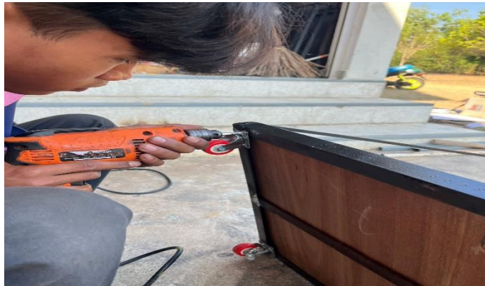
ภาพที่ 3.2.8 การยิงสกรูติดล้อ (ที่มา : นายจรรย์ศ ทอประเสริฐ และคณะ 2568)
