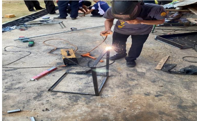
ภาพที่ 3.2.2 การเชื่อมชิ้นโครง (ที่มา : นายขจรยศ ทองประเสริฐ และคณะ 2568)
