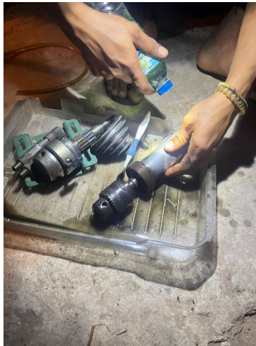
ภาพที่3.5 ล้างชิ้นส่วนของสว่านแท่น
