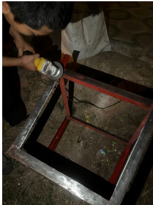
ภาพที่3.6 ขัดสีฐานเครื่องและทำการพ่นสีใหม่
