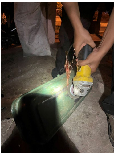
ภาพที่3.7 ขัดสีฝาครอบชุดหัวเครื่องและทำการพ่นสีใหม่
