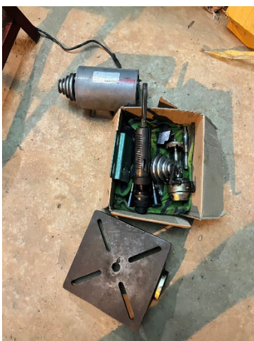
ภาพที่ 3.4 ชิ้นส่วนและอุปกรณ์ต่างๆของสว่านแท่น
