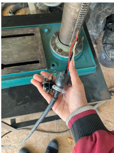
ภาพที่3.9 ต่อหัวปลั๊กสายไฟ
