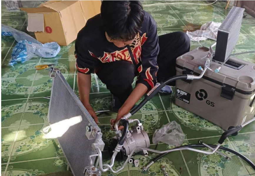
ภาพที่ 11 การทำสุญญากาศ (Vacuum) ระบบเพื่อไล่ความชื้น
