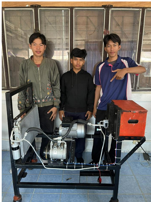
ภาพที่14 สมาชิกผู้จัดทำและชุดฝึกทักษะระบบปรับอากาศรถยนต์ (Isuzu D-Max)
