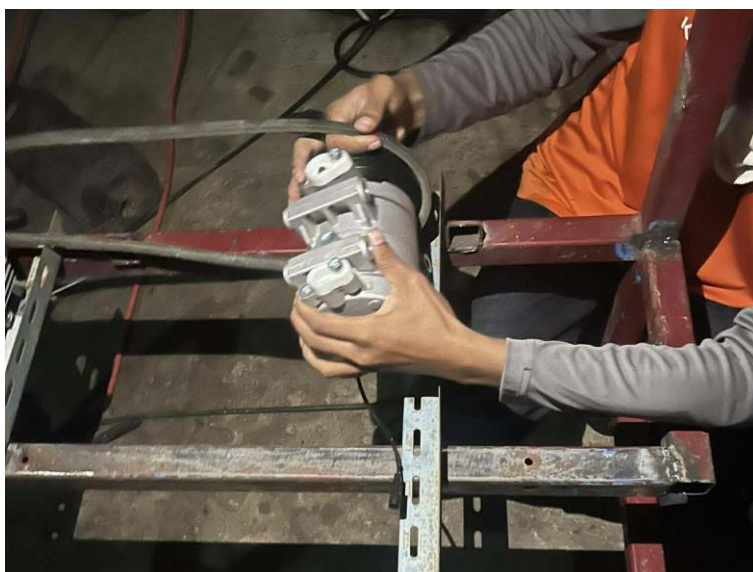
ภาพที่ 3.3.2 แสดงการติดตั้งคอมเพรสเซอร์และการปรับตั้งสายพาน
