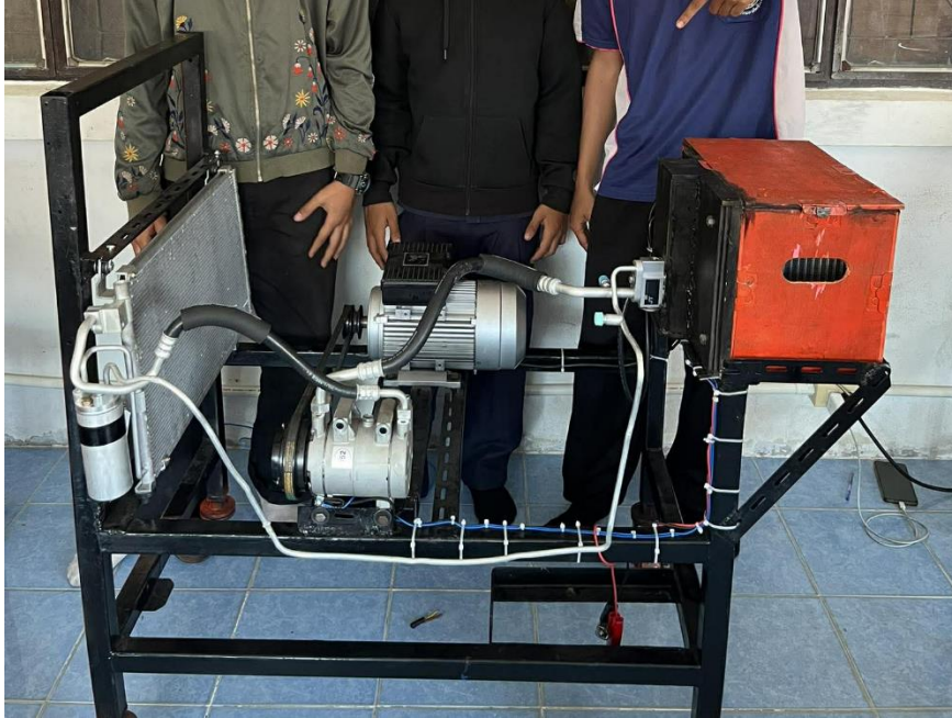
ภาพที่14 สมาชิกผู้จัดทำและชุดฝึกทักษะระบบปรับอากาศรถยนต์ (Isuzu D-Max)
