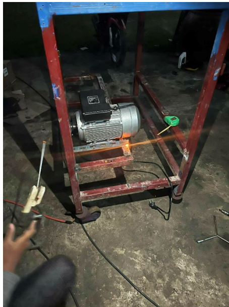
ภาพที่3.6 ติดตั้งมอเตอร์
