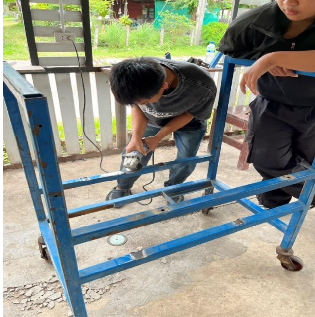
ภาพที่ 3.3 ซัดสีเดิม ซัดปรับสภาพพื้นผิวโดยกำจัดชิ้นส่วนเดิมออกทั้งหมด เป็นกระบวนการเตรียมพื้นผิวก่อนดำเนินการในขั้นตอนถัดไปเพื่อให้โครงสร้างมีความพร้อมสำหรับการประกอบ
