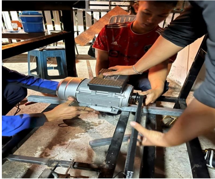
ภาพที่ 3.9 เทียบอุปกรณ์มอเตอร์และคอมเพรสเซอร์และวัดระยะสายพานให้ มีความยาวขนาดพอดีไม่ตึงเกินไปหรือหย่อนเกินไปเพื่อจะเชื่อมยึดกับโครงงาน
