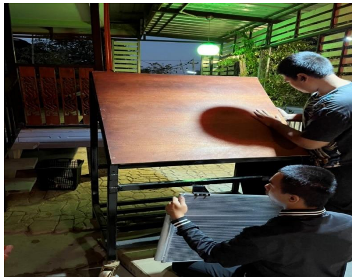
ภาพที่ 3.8 ติดแผ่นไม้โดยนำแผ่นไม้ที่ผ่านการพ่นสีเคลือบผิวเรียบร้อยแล้ว มายึดติดกับโครงสร้างหลัก ด้วยสกรูหรือตะปู
