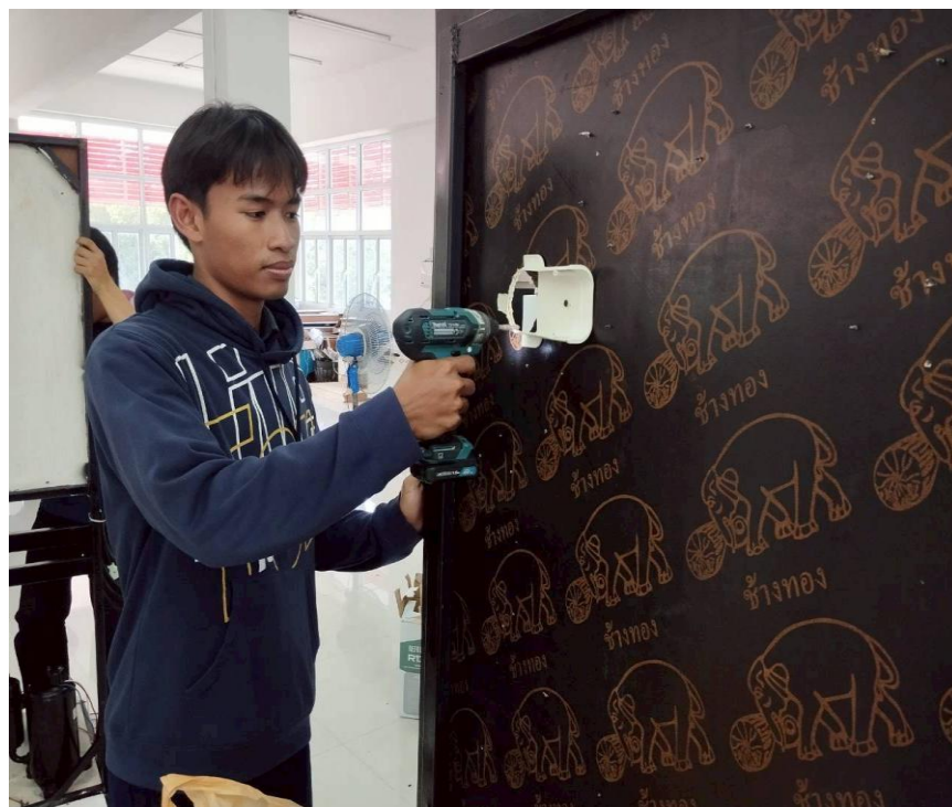
รูปภาพที่ 8 เจาะรูเพื่อนำชุดแอร์ด้านหลังมาประกอบ
