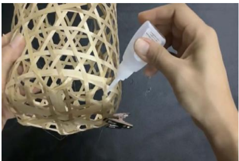
รูปภาพที่ 5 หยอดกาวเพื่อเพิ่มความแข็งแรง
