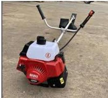
รูปภาพที่ 2.1.1 เครื่องตัดหญ้าแบบสะพายป่า เครื่องยนต์เบนซิน 2 จังหวะ
