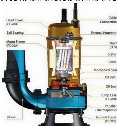
2.3.8 แสดงภาพตัวอย่างหลักการทำงานของปั๊มแช่ ไดโว่
