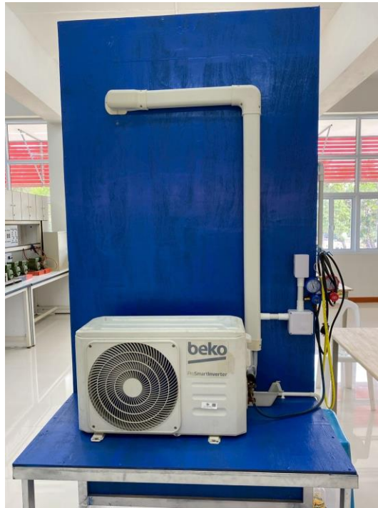
รูปภาพที่ 9 นำฝารางมาประกอบด้านหลังและทดลองใช้งาน
