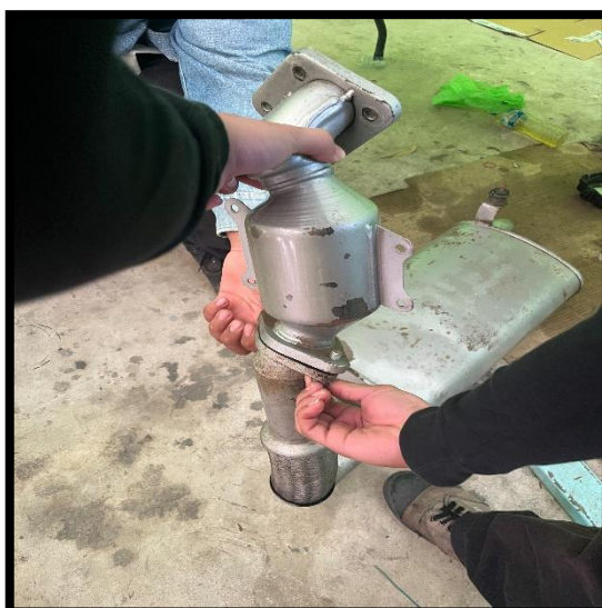
ภาพที่ 3.2 ทำความสะอาดหม้อพักท่อไอดี
