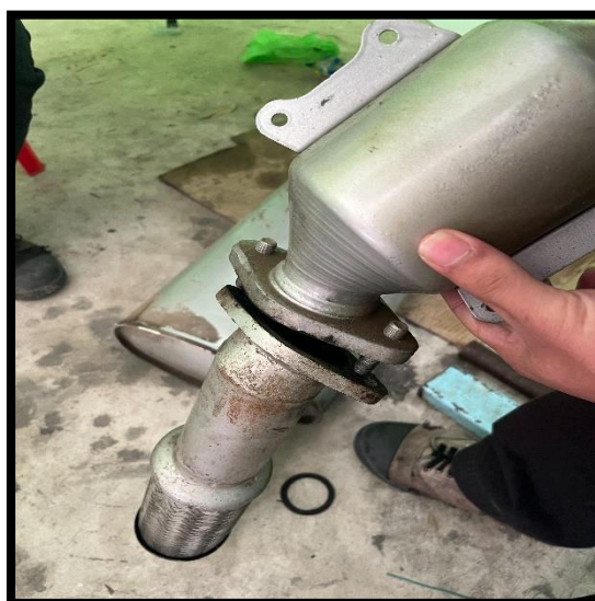
ภาพที่ 3.4 นำหม้อพักมาประกอบเข้ากับท่อส่วนปลาย
