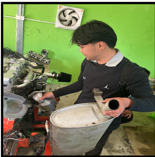
ภาพที่ 3.5 นำท่อไอเสียรถยนต์มาใส่เข้ากับท่อร่วมไอเสีย
