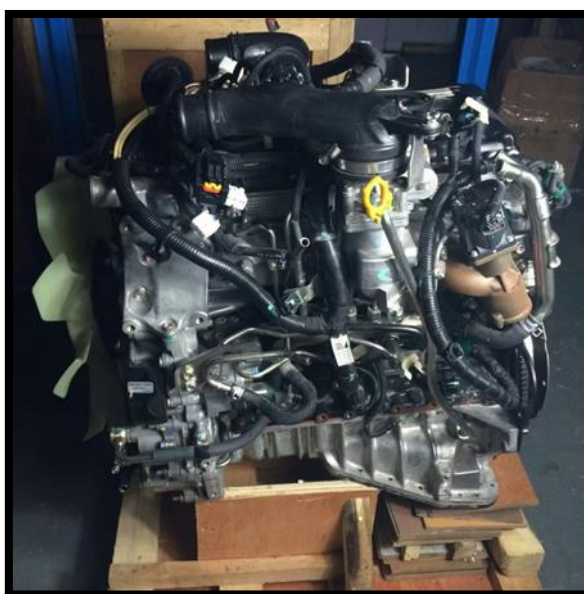
ภาพที่ 2.1 เครื่องยนต์4JK1(ระบบท่อไอเสีย)
